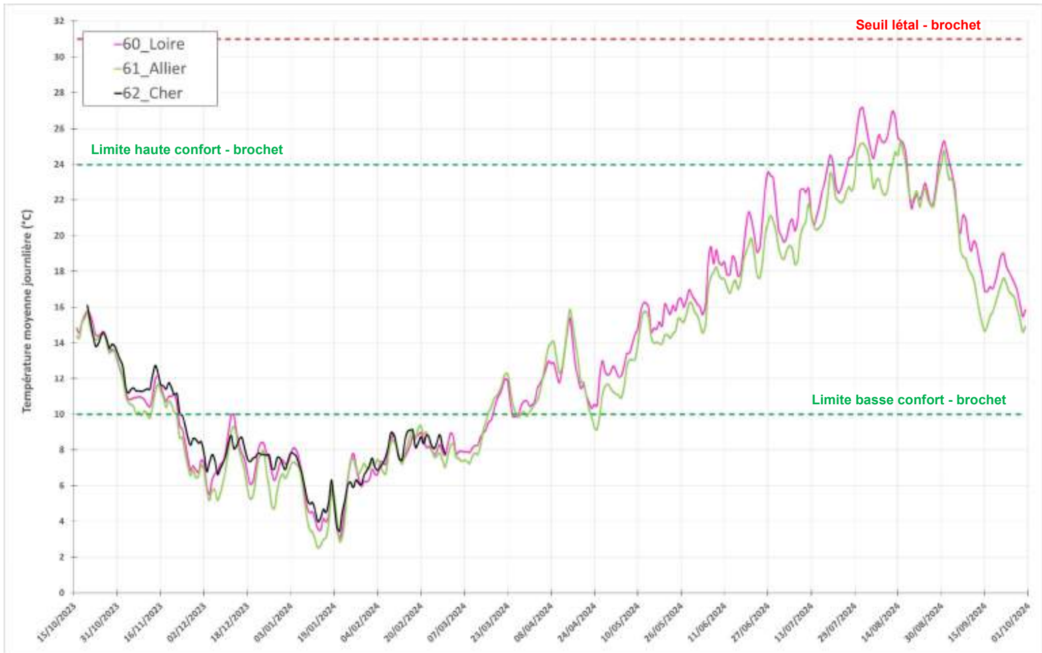
Figure 17 : Régimes thermiques des cours d'eau au droit des stations situées en contexte cyprinicole
