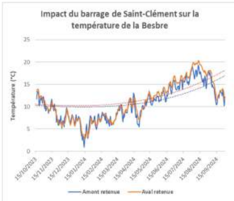
Figure 4 : Impact de la retenue de Saint-Clément sur les températures moyennes journalières de la Besbre en 2024
